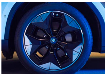
Aerodynamisch geformte Felgen wie die des BMW iX3 können die Reichweite eines E-Autos um ein paar Kilometer erhöhen
