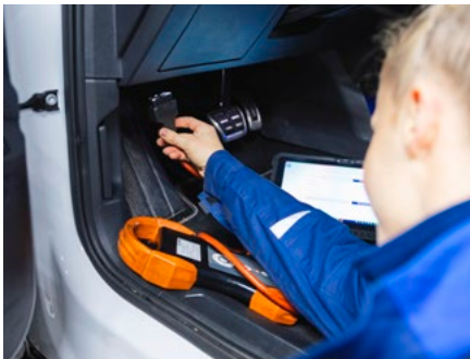
Batteriecheck per Diagnose: Der „State of Health“ (SOH) lässt sich auslesen
