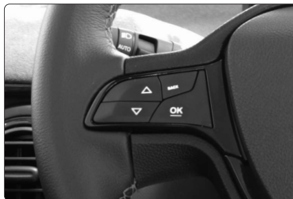
Abb. 46 - Tasten für den Zugriff auf das Menü der Instrumententafel.
