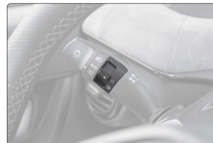
Abb. 104 - Lichtschalterhebel - Seitlich links vom Lenkrad.
