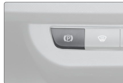
Abb. 37 - Taste zur Betätigung der Feststellbremse.
