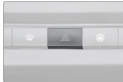
Abb. 39 - Taste zur Betätigung der Warnblinkanlage.
