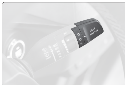
Abb. 29 - Fahrstufenwahlschalter - Befindet sich am Ende des Hebels, rechts hinter dem Lenkrad.
