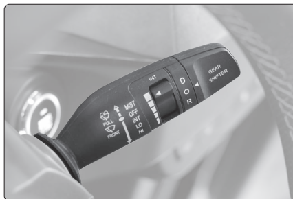
Abb. 108 - Scheibenwischerhebel - Seitlich rechts vom Lenkrad.
