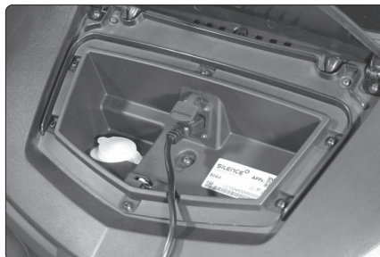
Abb. 120 – Anschlussstelle an das Fahrzeug.
