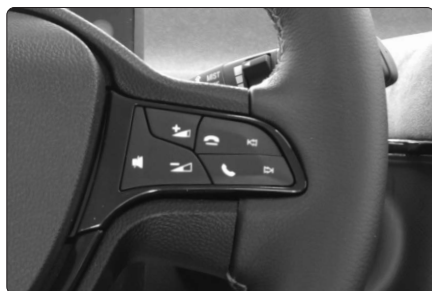
Abb. 66 - Steuertasten des Telefons und des Audiogeräts.
