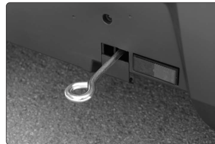
Abb. 16 - Anbringen der Abschleppöse an der Rückseite.
