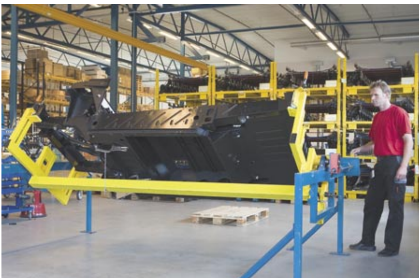
Mit dem Chassis startet die Produktion. Das Stahlteil wird vorgefertigt aus Thailand angeliefert und trägt später das gesamte Auto.
