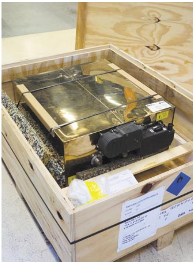
Heißer Akku: Die Zebra-Zelle arbeitet mit einer etwa 300 Grad Celsius warmen Salzschmelze und speichert 28 Kilowattstunden Strom.
