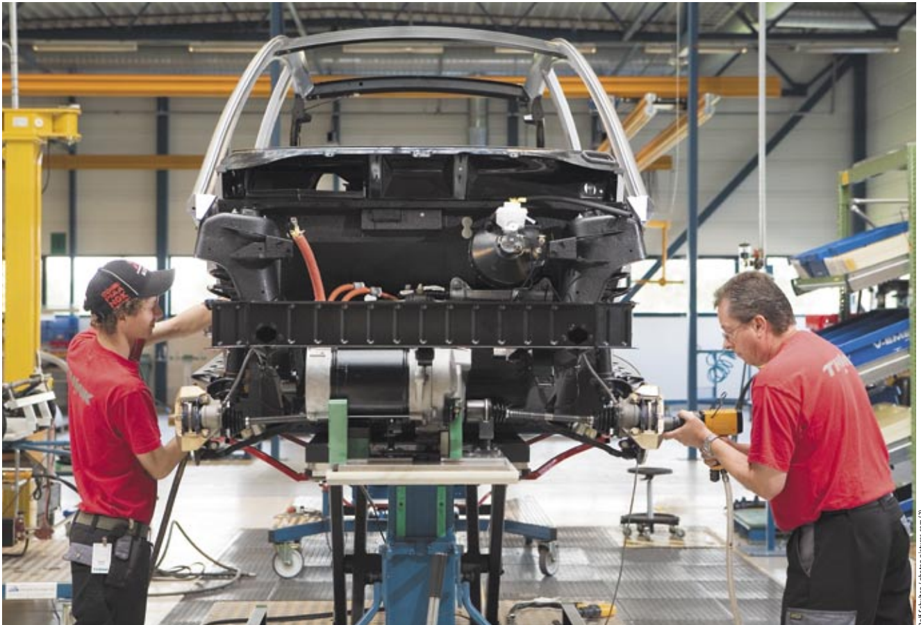
Nur elf Montagestationen gibt es an der Fertigungsstraße. Hier wird gerade der Motor von unten in das Chassis gehoben.
